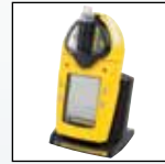
Integrierte Pumpe und Akkuladegerät
